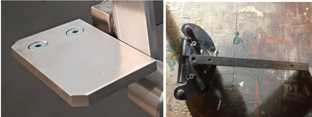
1. Befestigung der Arbeitsplatte
